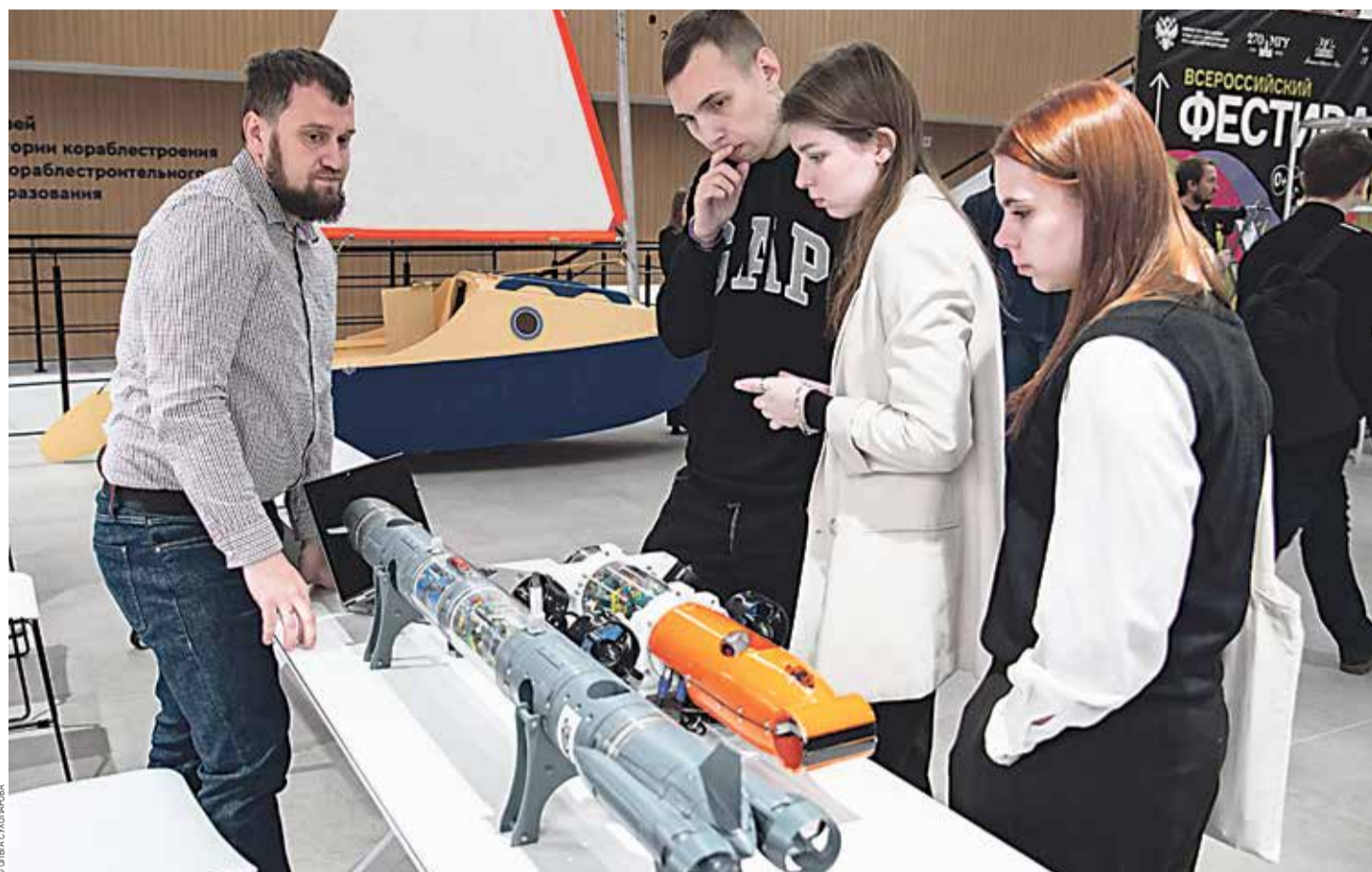
Телеуправляемый необитаемый малогабаритный подводный аппарат «Вариола» и автономный необитаемый подводный аппарат «Акра»
